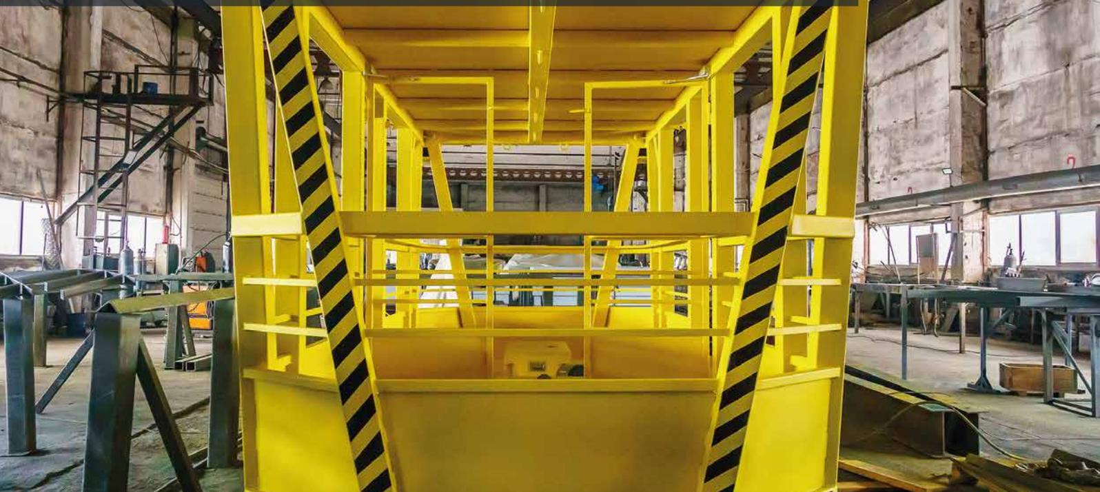
В производстве кабины применялись ключевые производственные мощности нашего предприятия: **лазерная и плазменная резка металла, гибка, сварочные работы.** Последний этап - **антикоррозийная защита и покраска с нанесением сигнальных линий и маркировки.**
